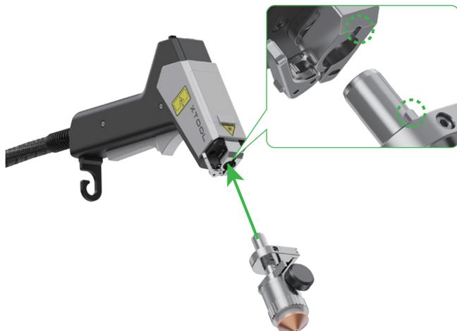
Allineare la linguetta della punta di taglio con la scanalatura sulla torcia di saldatura, e poi inserire la punta di taglio.
