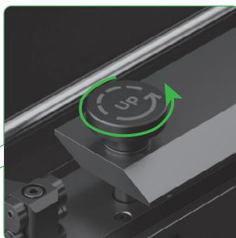
(4) Ruotare la manopola di dispositivo di bloccaggio sinistro in senso antiorario.
