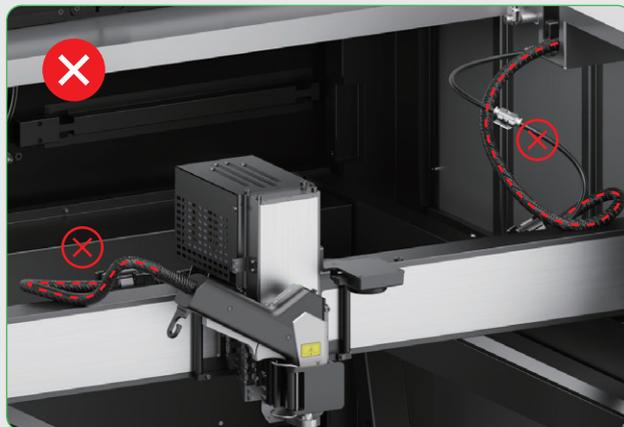
(7) Utilizzare il blocco di fissaggio del cavo per fissare l'anello di fissaggio nella fessura destra della macchina.
