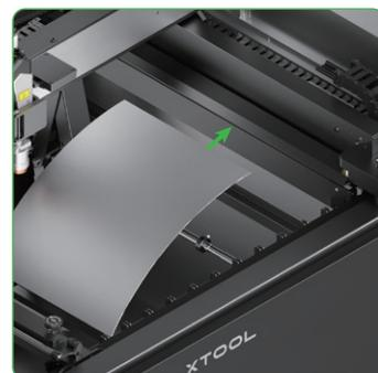
(2) Inserire il lato destro del materiale nel dispositivo di bloccaggio destro.
